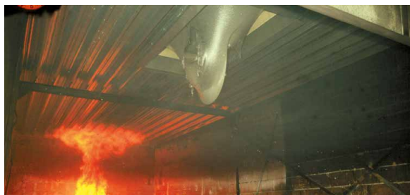
Lichtkuppel aus Acrylglas als Wärmeabzug.
