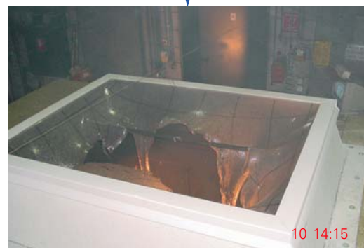
Brandversuch nach DIN 18 232-4: Lichtkuppel aus PMMA, Außenschale 3 mm, Innenschale 2 mm Brandlast: 48 kg Holz
