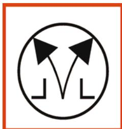
Symbol „Bedienstelle für Rauch- und Wärmeabzugseinrichtung“ nach DIN 14034-6
