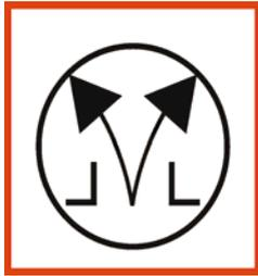
Bild 6: Symbol „Bedienstelle für Rauch- und Wärmeabzugseinrichtung“
