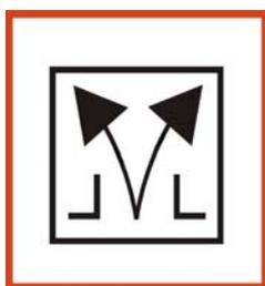
Symbol „Rauch- und Wärmeabzugseinrichtung“ nach DIN 14034-6
