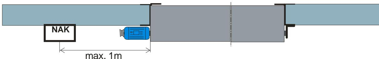
Bild 4: Positionierung von Bedienstellen bei Toren ohne separate Fluchttür
