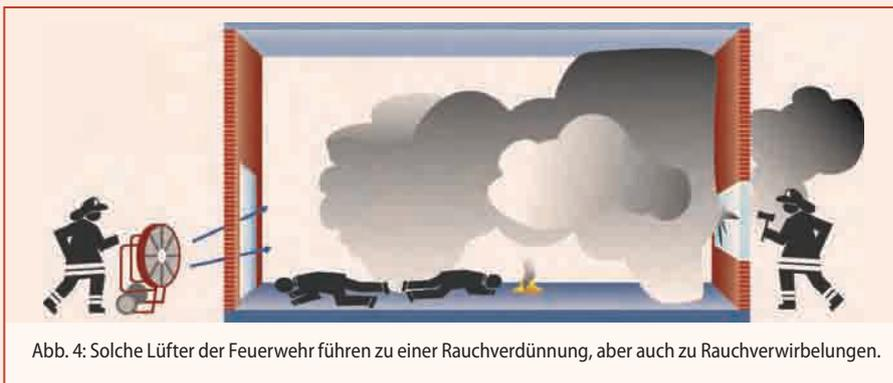
Abb. 4: Solche Lüfter der Feuerwehr führen zu einer Rauchverdünnung, aber auch zu Rauchverwirbelungen.
