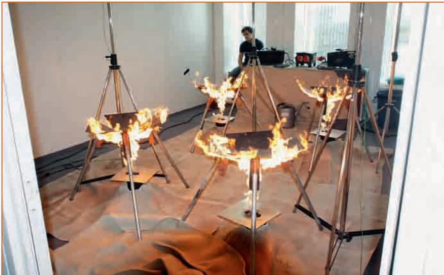
Abb. 3: Realbrandsimulationseinrichtung in einem kleinen Raum
