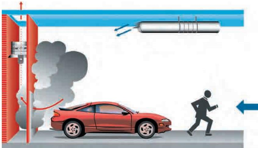
Abb. 3: Wirkungsprinzip des Jet-Ventilations-Systems
