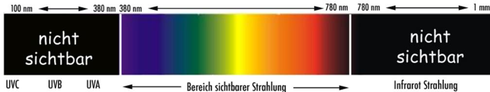
Bild 1: Aufteilung der optischen Strahlung in Bereiche
