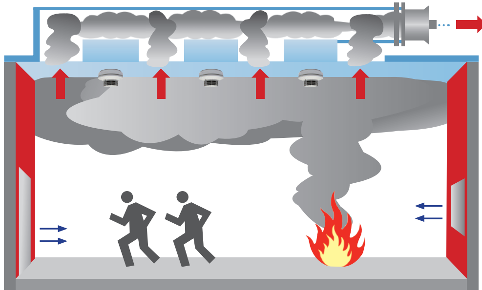
Abbildung 5.5.3: Prinzip der maschinellen Entrauchung
