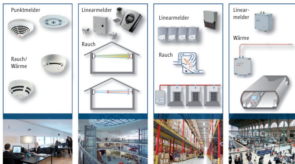
Abbildung 5.1.2: Einsatzgebiete von diversen Brandmeldern
