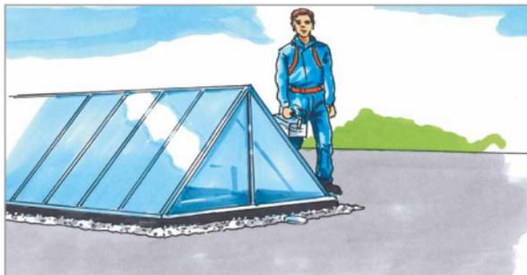
der Dachebene – beispielsweise auf 50 cm – nicht völlig ausschließen. Jede Erhöhung des Aufsetzkranzes verschlechtert außerdem durch die Schachtwirkung die Lichtausbeute unter dem Oberlicht, was sich vor allem bei kleinen Abmessungen nachteilig bemerkbar macht.
